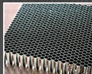
Materiale di rinforzo a nido d'ape d'alluminio - Nomex
